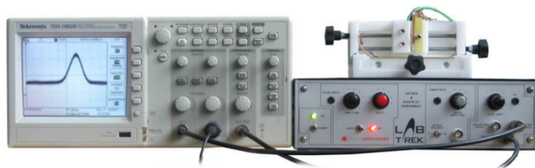
Abbildung 4.1.: Verwendeter Versuchsaufbau für das Haynes&Shockley-Experiment [AM, 46]
