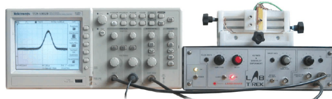
Abbildung 11: Versuchsaufbau des Hanley und Shockley Experiments 2
