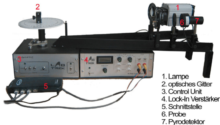
Abbildung 4: Versuchsaufbau zur Vermessung der Bandlücke
