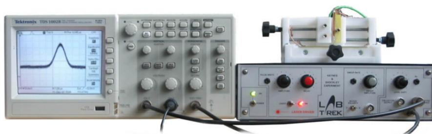
Abbildung 11: Versuchsaufbau des Haynes & Shockley Experiments bestehend aus einem Oszilloskop (links), dem Netzgerät (rechts), von dem aus die Signale ans Oszilloskop geleitet werden, und der Germaniumprobe (oben), auf dessen Oberfläche die Nadel angebracht sowie ein Laserpuls mittels eines Lichtleiters gerichtet ist [5, S.46].
