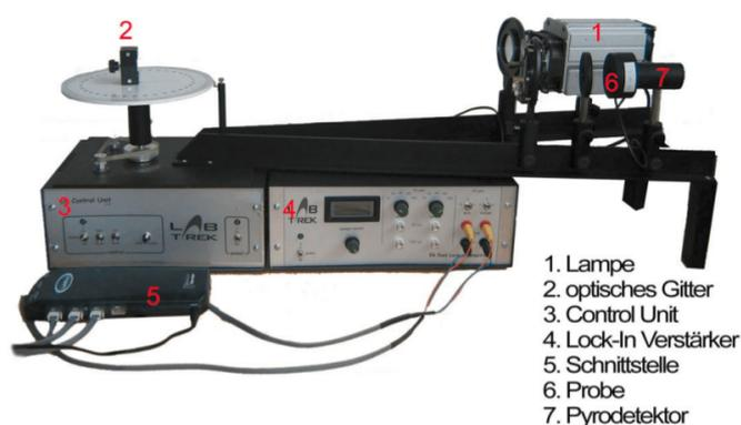
Abbildung 5: Grundsätzlicher Aufbau des Experiments zur Vermessung der Bandlückenenergie. [1, S.3]
