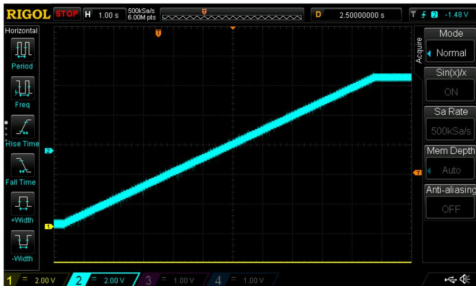
**Abbildung 3:** Spannungssignal des durchfahrenden Rampenstroms wie es am Oszilloskop aufgezeichnet wurde.
