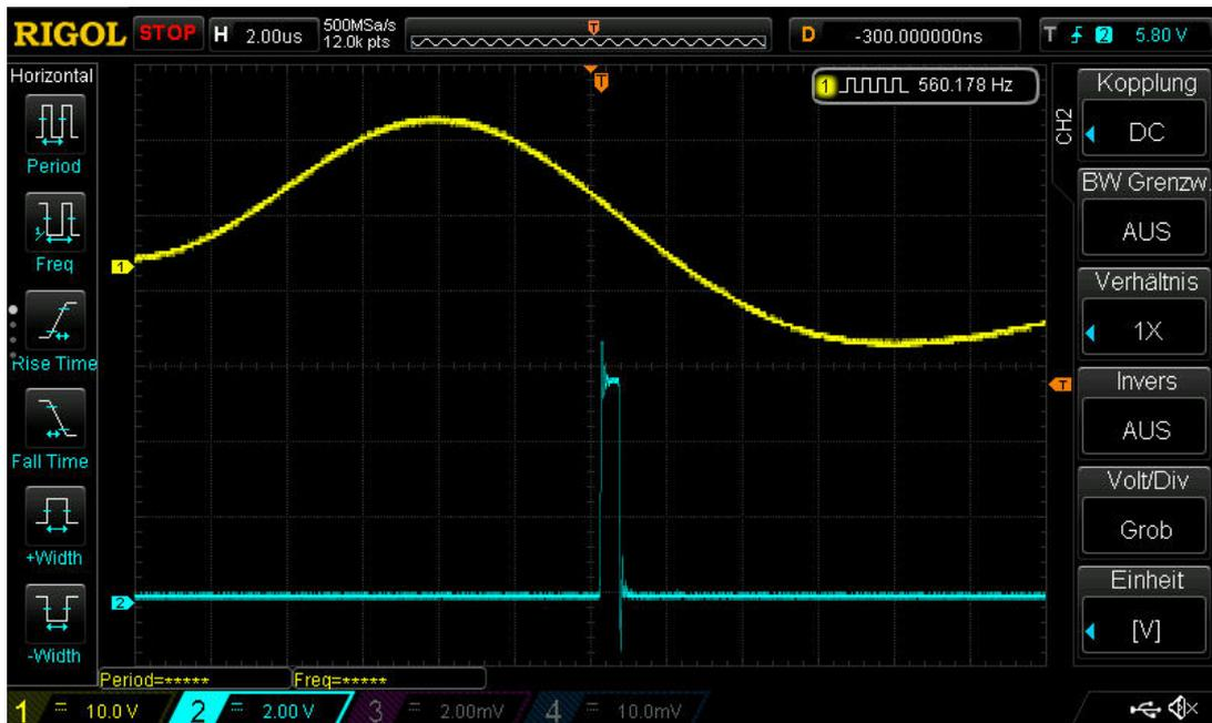
**Abbildung 5:** Anzeige des Oszilloskops um die Einflüsse verschiedener Einstellungen zu vergleichen. In gelb ist das Signal des unipolaren Outputs des Hauptverstärkers dargestellt, in blau das positive Output Signal des Timing Single Channel Analyzers. Dass beide Signale gleichzeitig sichtbar sind bedeutet sowohl, dass ein Zerfall stattgefunden hat als auch, dass dieser vom Timing SCA als Zählsignal aufgenommen wurde.
