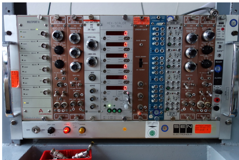
Abbildung 4: Ein Bild der Geräte, wie sie im aktuellen Aufbau verfügbar sind. Von links nach rechts: 1. Multi-Channel-Analyser (im Aufbau Multiport II), 2./10. Amplifier (zu beachten ist, dass die Amplifier nicht zwingendermaßen die selben Ergebnisse liefern, auch wenn es eigentlich das gleiche Modell ist), 3./9. Single-Channel-Analyser (im Aufbau Timing SCA), 4. Fast Amplifier (nicht genutzt), 5. Hex-Counter (im Aufbau Hex-Scaler), 6. Linear Gate, 7. Koinzideeinheit, 8. Timing Unit, 11. nicht genutzt (Bild entnommen aus [Anl])
